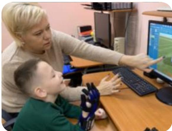
Реабилитационный комплекс «Аника» используется на основе биологической обратной связи. С помощью специальной перчатки, оснащенной датчиками движения, ребенок управляет игрой на экране компьютера и тренирует движения.
